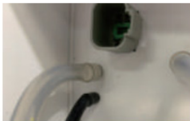
2. Horní je připojen k hadici na mléko a spodní připojený na čisticí hadici
