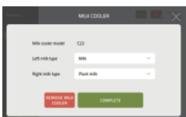
10. Vstupte do nabídky kávovaru, zvolte System-Accessory-Milk chladič a nainstalujte chladič mléka podle pokynů
